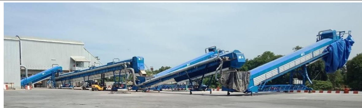
รูปที่ 2-28 การขนถ่ายสินค้าบริเวณโรงกลั่นสินค้า B และสายพานลำเลียงมันเส้นเข้าซึ่งเป็นระบบปิด
