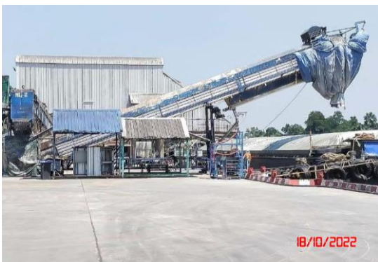
รูปที่ 2-7 เครื่องดักจับฝุ่น (Bag Filter) ติดกับโกรกลงสินค้า B พร้อมท่อดูดฝุ่นจากสายพานลำเลียงมันเส้น
