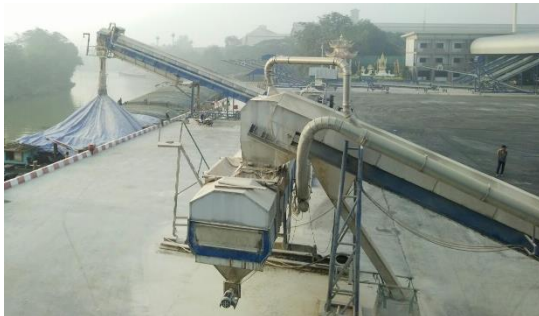
รูปที่ 2-26 ท่อดูดฝุ่นจากผ้าใบเข้าสู่เครื่องดักจับฝุ่นบริเวณโรงกลั่นสินค้า
